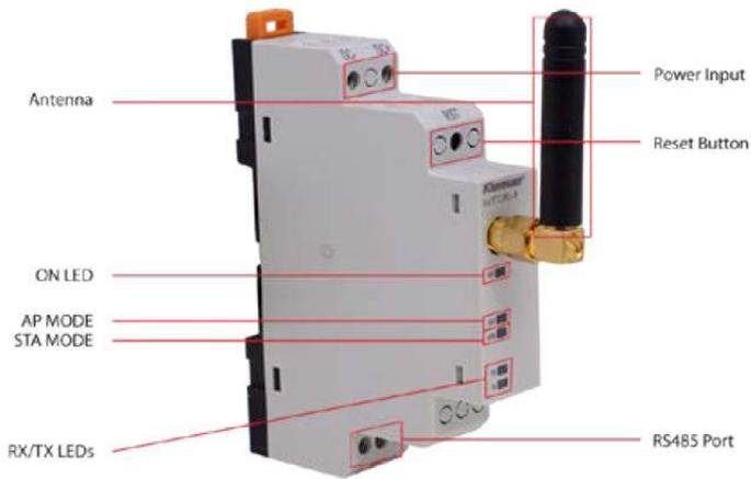
Il modulo WTOR può lavorare sia come AP (Access Point) creando la sua rete, sia come STA (Station) connettendosi ad un Access point esistente.
