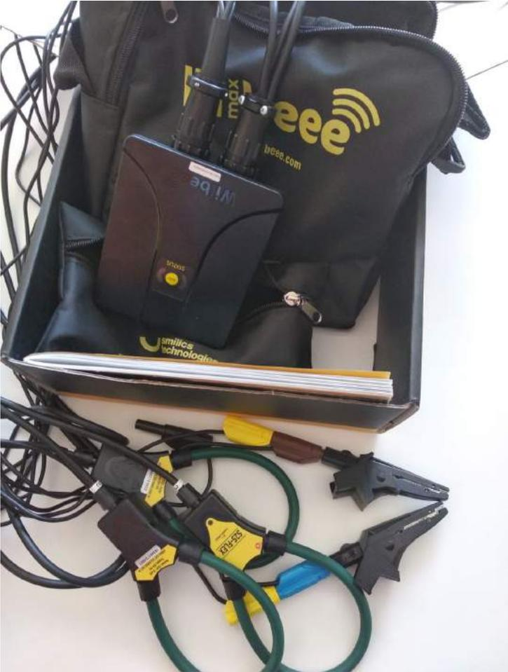
WIBEEE MAX è la soluzione pratica e facile da installare per eseguire dei monitoraggi di consumi elettrici. E’ dotato di tre sonde di rogowski con scala configurabile 100 A -1000 A -5000 A, un kit di connettori e morsetti per l’installazione in tutta sicurezza.
